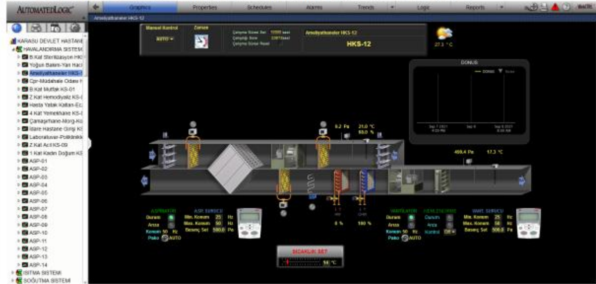
Resim 32 AUTOMATEDLOGIC® MERKEZİ HAVALANDIRMA ÜNİTESİ KONTROL PANELİ ÖRNEK GÖRSELİ (HKS-12)
